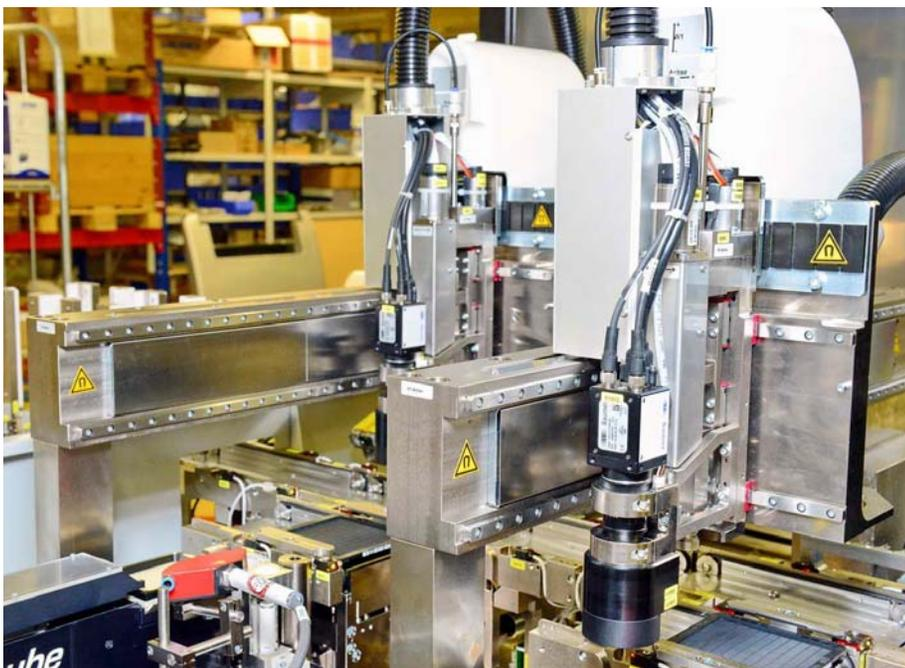
**Infotech IP-100 Kleinstteil-Bestückungsanlage.** Dank der kompakten Bauweise im kartesischen Portalsystem werden Fertigungsprozesse auf kleinster Fläche ermöglicht.
