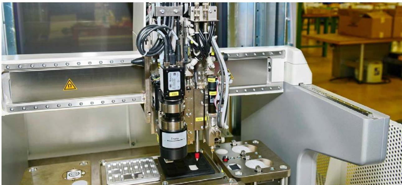
Die Infotech IP-500 Halbleiter-Labordosier- und Bestückungsanlage. Jitterfreie Verfahrwege bilden die Basis für genaue Prozesse.
